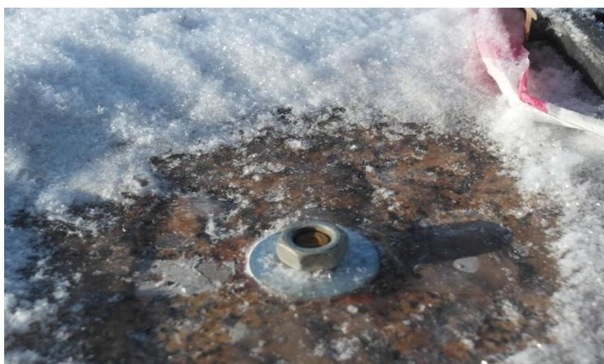
Рисунок 23 - Долговременный опорный пункт (Тип 4)
