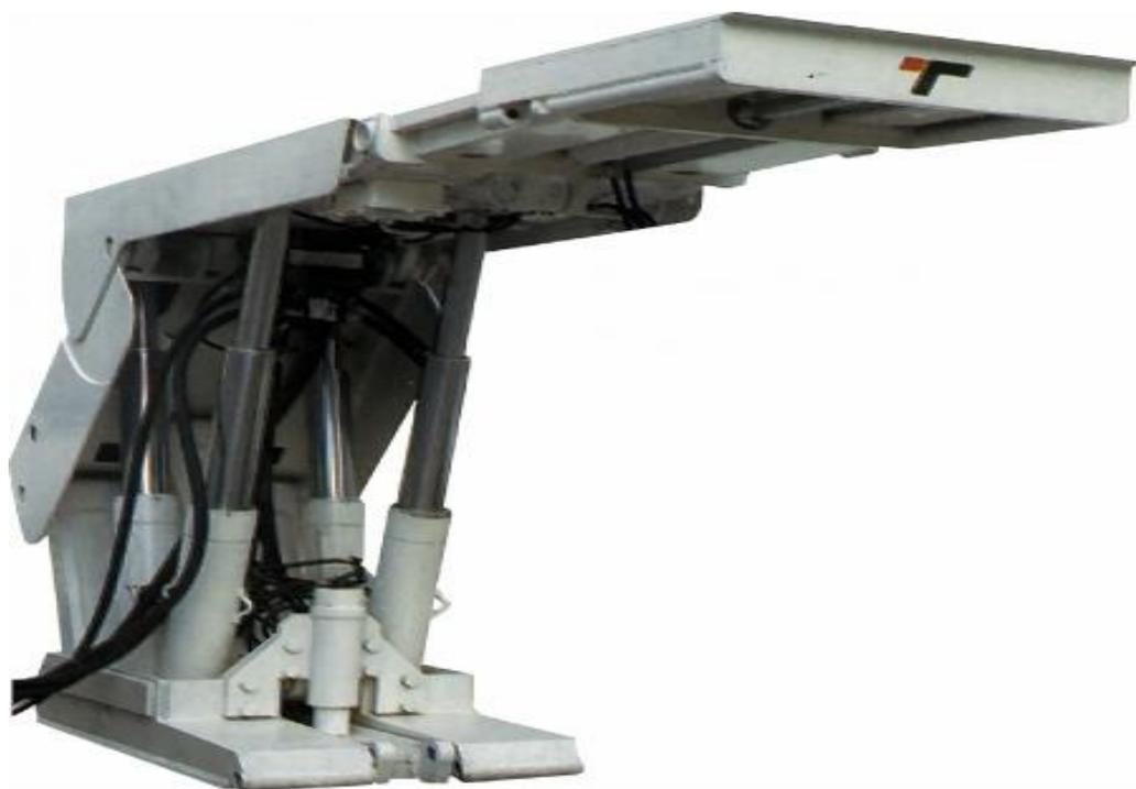
Рисунок 6 – Проходка забоя механизированной крепью ЩН-1С
