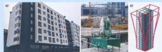
Рис. 3. Расположение контрольных марок на объекте (а); мониторинг здания с применением роботизированного электронного тахеометра (б); общая схема GPS-мониторинга ветрового воздействия на высотное здание (в).
