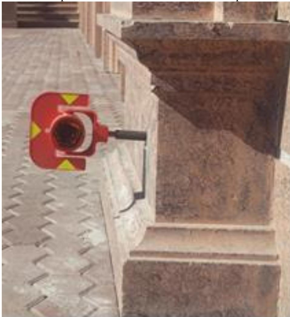
Рисунок - 36 - Мониторинговые точки на стенах здания
