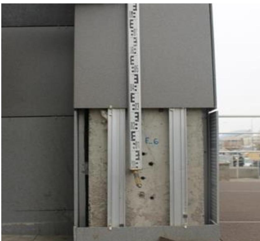
Рисунок 32 - Мониторинговые нивелирные точки на колоннах здания
