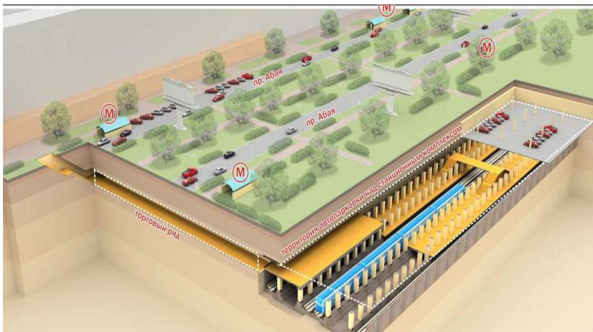
Рисунок 14 – Схема технологии строительства станции с опережающей крепью
