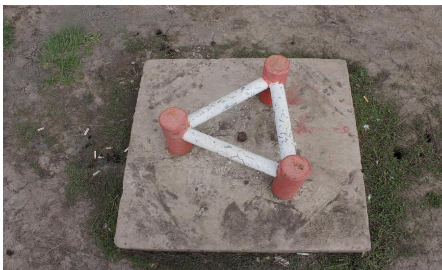
Рисунок 20 - Долговременный опорный пункт (Тип 1)
