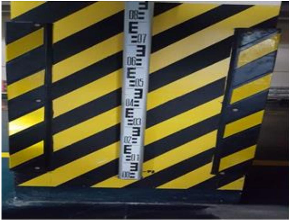
Рисунок 33 - Мониторинговые нивелирные точки на колоннах цокольного этажа здания и паркингов
