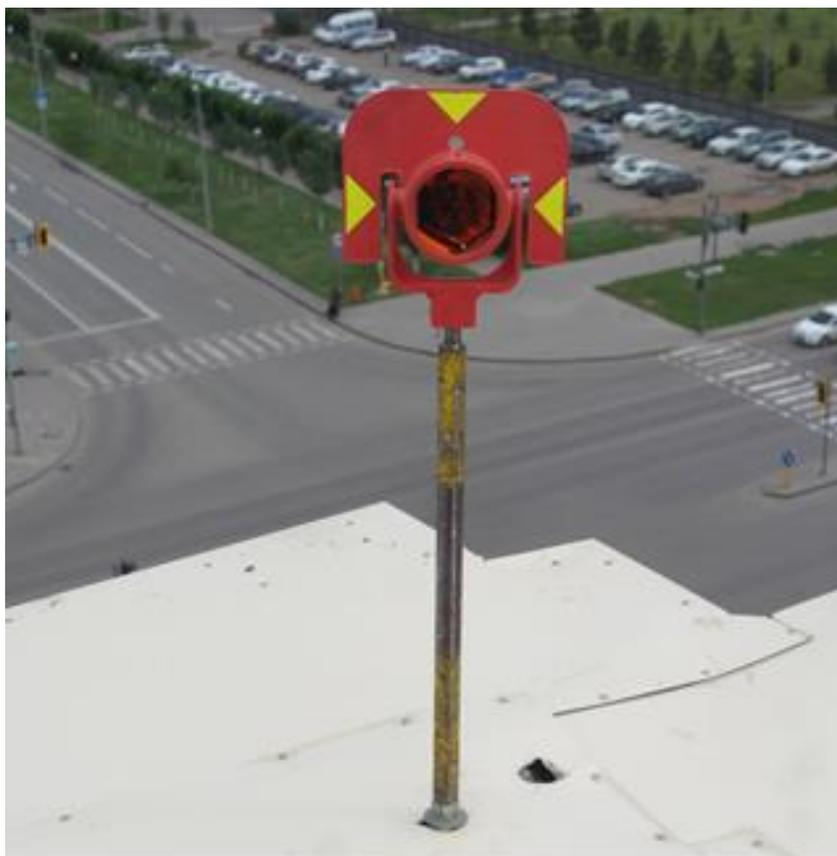
Рисунок 31 - Мониторинговые точки на крыше здания
