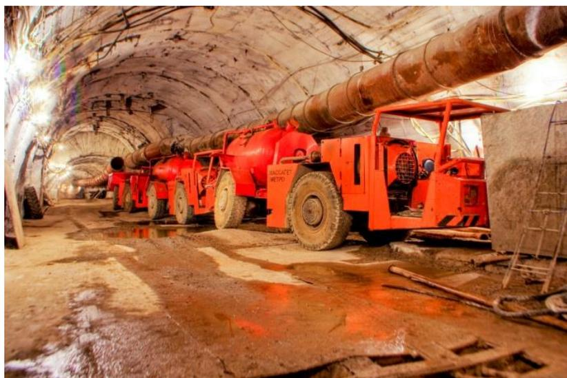
Рисунок 11 - Бетоно-транспортная машина на базе ТСШ-46
