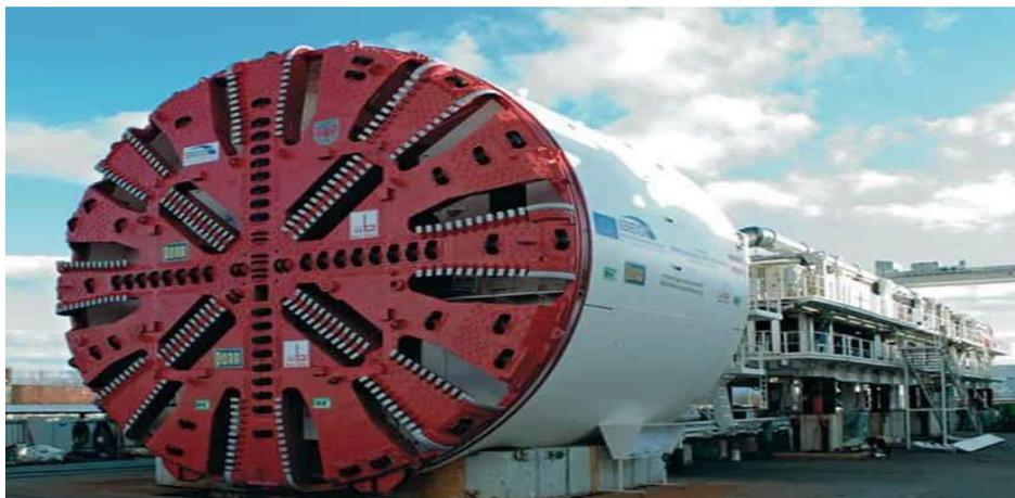
Рисунок 7- Проходка забоя механизированным щитом КТ-5,6
